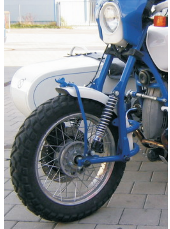
BMW R80 GS Basic, Hagon Federbeine, 17" Hinterradfelge mit Reifen auf VR Nabe gespeicht, GfK 15" Kotflügel mit Strebe, Sonderfarbe Enzianblau
