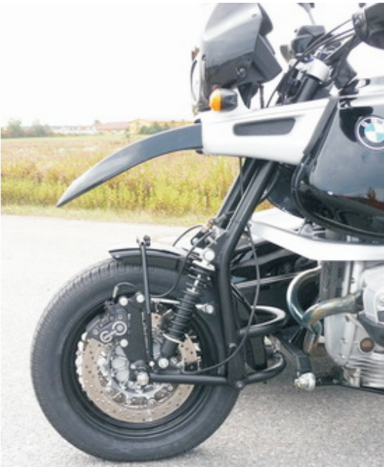
BMW R1100GS, tiefer gelegt, Bilstein Federbeine
